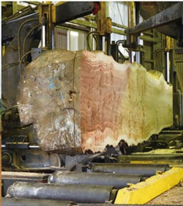
福岡県大川市の工場に運ばれてきた丸太を製材機に乗せ、回転させながら鋸を入れる角度を決めます。年輪や木材の状態などを見て、最適な角度を探し出し、全体の挽き方を考えます。挽きながら面剛や角度をさらに調整。木を諂ひの目、長年の経験で培った職人の腕が物を言う工程です。
