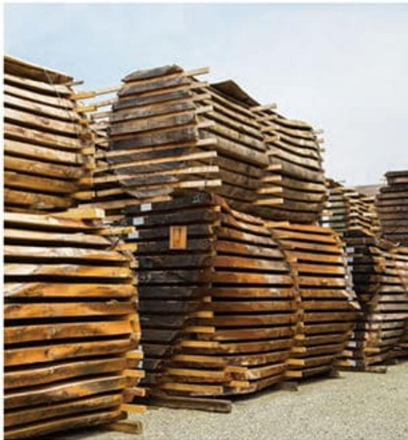
板の乾燥には2年から長い物で10年以上を要します。製材された板が30,000枚以上積みされ、まずは自然乾燥。木の水分量を計測しながら調節を続けます。水分がある程度落ちたら、人工乾燥窯に入れ、含水率を調整して、ようやく一枚板の仕込みが完了します。
