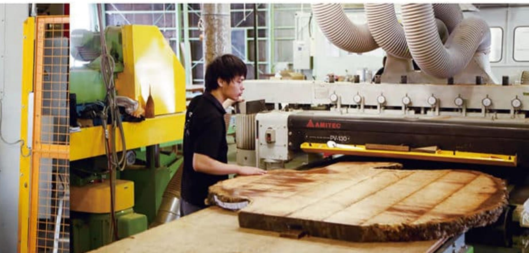
バーチカルミーリングマシンを使い、表面の凸凹した部分を削り、板を平らにします。MOKUBAのマシンは日本最大級。長さ12m・幅1m35cmまでの加工ができ、大自然のスケールを損なうことなく一枚板に仕上げることができます。平らになるまで何度も機械に通して削り出します。
