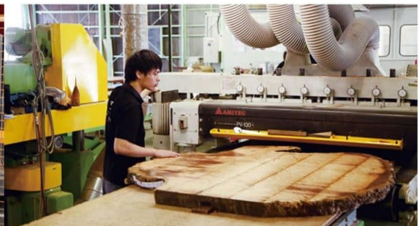
バーチカルミーリングマシンを使い、表面の凸凹した部分を削り、板を平らにします。MOKUBAのマシンは日本最大級。長さ12m・幅1m35cmまでの加工ができ、大自然のスケールを損なうことなく一枚板に仕上げることができます。平らになるまで何回も機械に通して削り出します。
